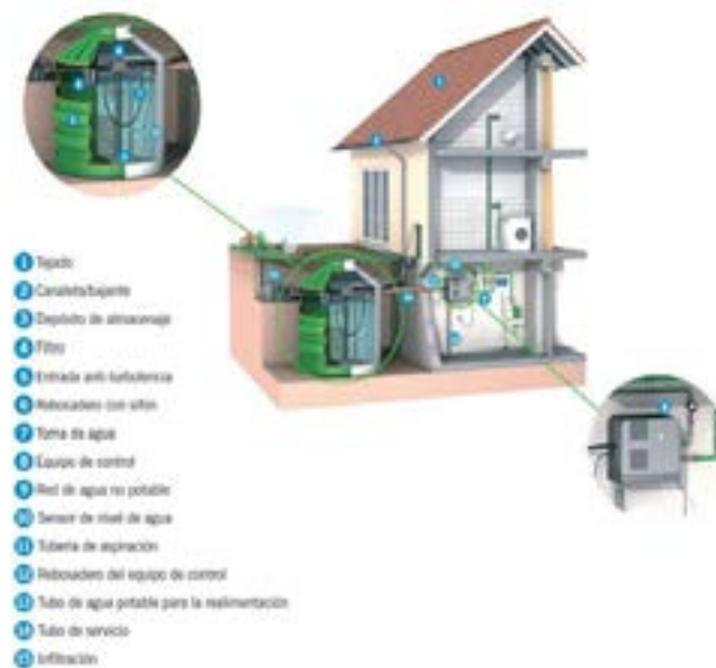
Sistema de recuperación de aguas pluviales
