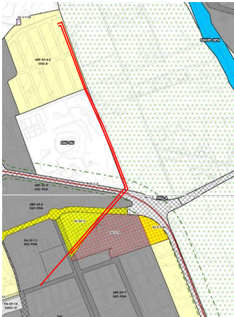
Superposición del trazado esquemático de las líneas eléctricas subterráneas, previstas en la innovación, sobre el Plano o.02 “Clasificación del Suelo” (memoria de ordenación)
