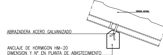
ANCLAJE CONDUCCION FUNDICION DUCTIL S/E
